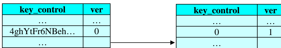
La procedura azzerava il campo “key_control” e lo marca come verificato impostando “ver” = 1
